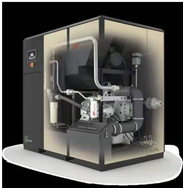
一、离心式空压机的工作原理离心式空压机属于速度式压缩机，离心式空压机是由叶轮带动气体做高速旋转，使气体产生离心力，由于气体在叶轮里的扩压流动，从而使气体通过叶轮后的流速和压力得到提高，连续地生产出压缩空气。二、离心式空压机的组成部分离心式空压机由转子和定子两大部分组成，转子包括转轴，转子包括叶轮和轴，叶轮上有叶片、平衡盘和一部分轴封；定子的主体是气缸，还有定位于缸体上的各种隔板以及轴承等零部件。三、离心式空压机的特点离心式空压机具有结构紧凑、易损件少、运转可靠、使用寿命长，大排量时效率高、节约能耗，产出洁净无油的压缩空气等特点。四、离心式空压机的分类离心式空压机可以分为空浮离心空压机（无齿轮）、普通式离心空压机，高压离心空压机、中压离心空压机，小型离心空压机、
